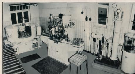
**Zu sehen von links nach rechts:** Flaschenspülung, Abfüllmaschine für Raboll-Limonade, Wasseraufbereitung und Versetzung mit Kohlensäure **in den 60ern.**
